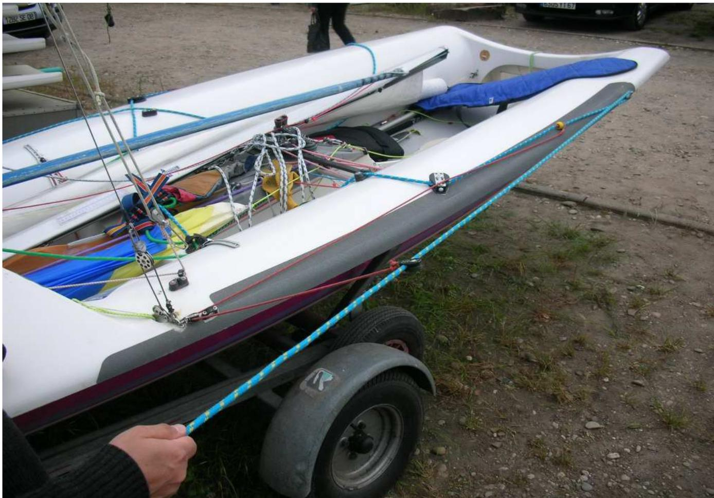
Problème propre au système : on ne peut régler le barber au vent une fois établi. Dommage... et C'est l'écoute de spi qui permet de régler le spi (contrairement au double tangon automatique)... pas bien grave
