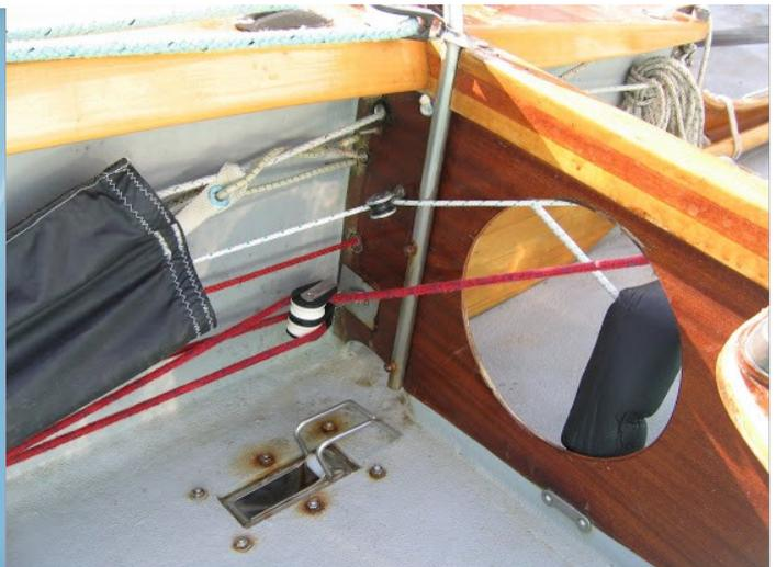
**Autre modèle gréement avec taquet de spi sur caisson et non sur platine :**
